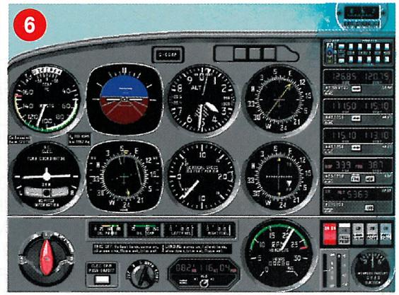
nung vom ILS-DME mit der Kennung WES auf der Frequenz 111.50 MHz vor. Nach einer Rechtskurve soll ein QDM von 168 Grad zum SLT NDB auf 387 kHz erfolgen werden. Nach erfolgtem Überfliegen ist ein QDR von 135 Grad von diesem Funkfeuer vorgesehen.
