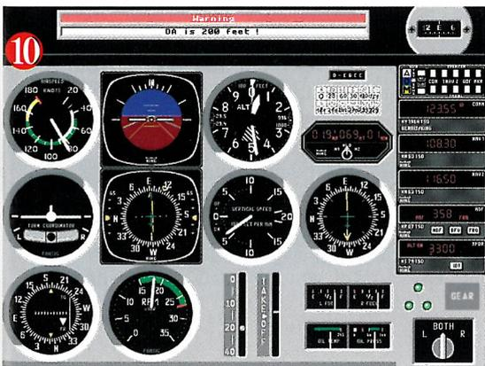
Die Minimum-Sinkflughöhe ist erreicht. Besteht in dieser Situation keine Erdsicht, muß das Fehlflugverfahren eingeleitet werden
