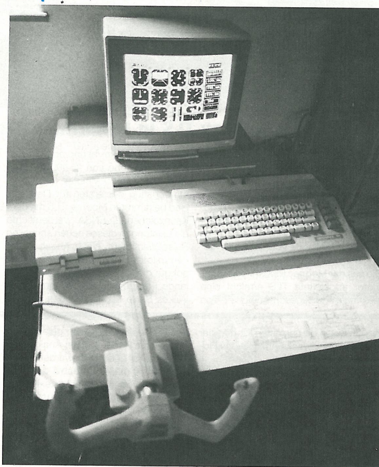
Der Light Aircraft Simulator (LAS 89) hat sich in seiner jüngsten Version mit der Zusatzausstattung in Form von Steuerhorn und Analoggas zu einem vollwertigen Verfahrensübungsgerät entwickelt. Mit einem Trainer, der Anweisungen gibt und den Übenden kontrolliert, kann das Instrument sehr sinnvoll eingesetzt werden
